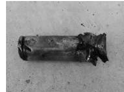
宮沢清掃センターで処理したごみの中から出てきた発火したリチウムイオン電池
