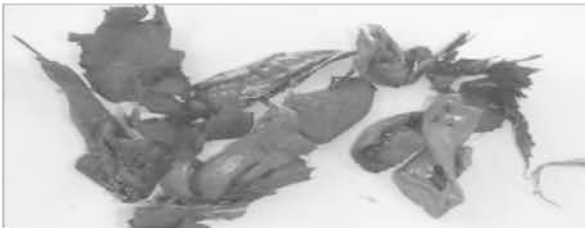
火災検知器の作動原因となった発炎筒
