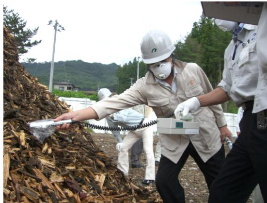
災害廃棄物（木質系可燃物）及び仮置場敷地境界の放射線量測定
