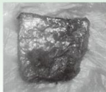
ビニール・プラスチック類処理ラインから出てきた焦げたリチウムイオン電池
